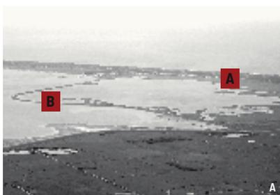
Der **Randdeich A** des Rantumbeckens ist 3,8 km lang und 4,55 m über NN hoch. Das Wasser innerhalb des Beckens sollte auf 2,5 – 3,0 m über NN aufgestaut werden. Der **Außendeich** oder »Sperrdamm« **B** dient als Schutz gegen die Nordsee und ist 5,2 km lang und 5,5 m über NN hoch. Um das Rantumbecken als Seewasserreservat zu erhalten, wird das Süßwasser von der Landseite und dem Schönungsteich im nördlichen Bereich separat in die Nordsee durch das Siel abgeleitet.
