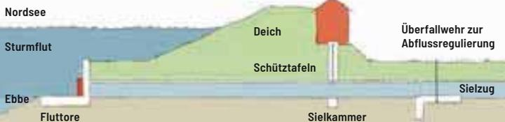
Am **Deichsiel** wird die Wasserspiegeldifferenz zwischen Sielzug und der Nordsee (bei Ebbe) zur Entwässerung genutzt. Die Sieltore öffnen sich bei Ebbe durch den Binnenwasserdruck und werden bei Flut durch den höheren Meerwasserdruck wieder verschlossen und somit das Einströmen von Salzwasser verhindert.
